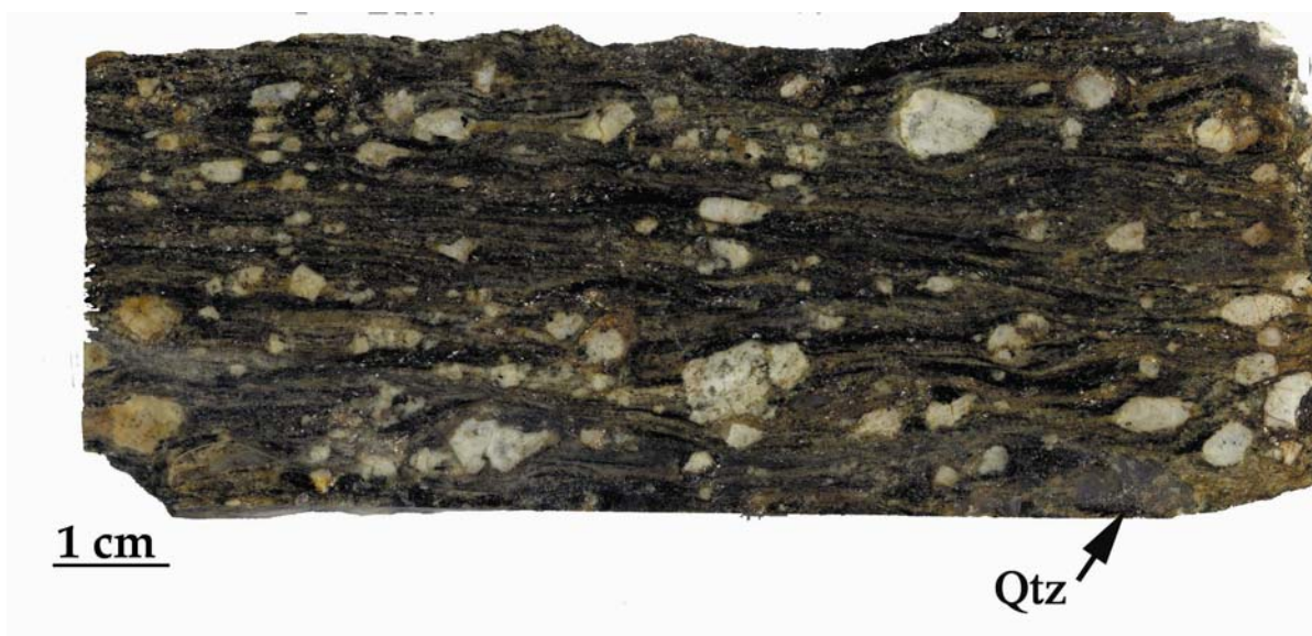
Foto 2.17: Con el aumento de la deformación y el metamorfismo, van desapareciendo los fenocristales de cuarzo ( Qtz ), a la vez que se va desarrollando una fábrica ( S2 ) marcada por dominios, unos con tonalidades claras (enriquecimiento en cuarzo y feldespatos) y otros con tonalidades oscuras (biotíticos). La Foto refleja un plano XZ, donde ya se comienzan a observar criterios cinemáticos. (Muestra: 229-26).
