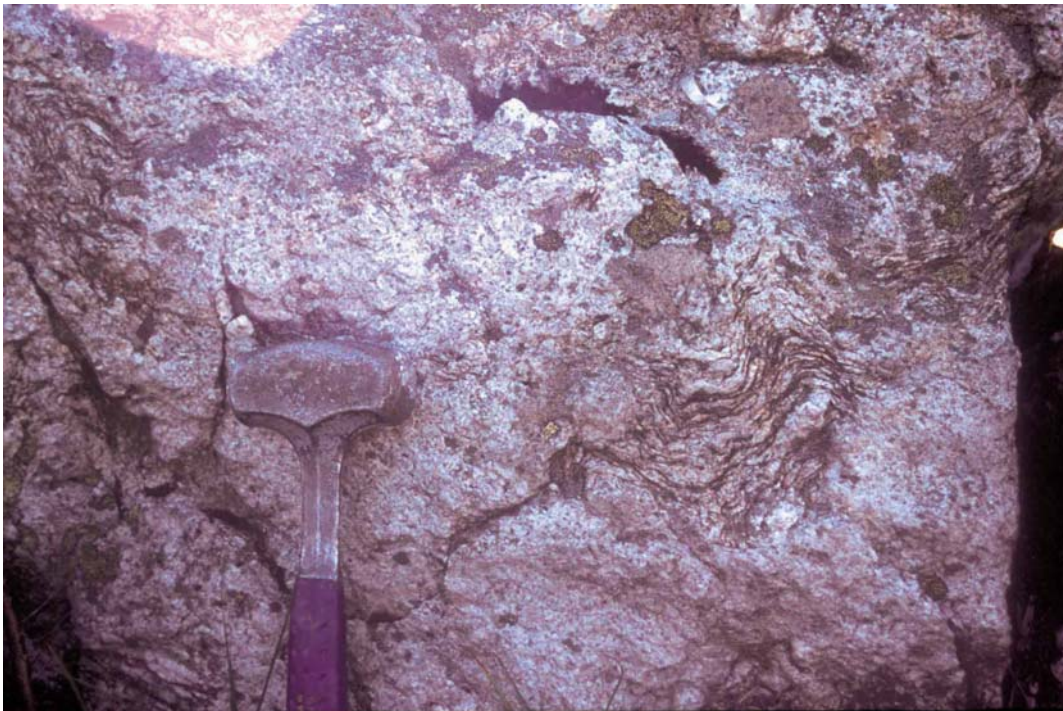
Foto 2.22: Restitas del ortogneis glandular en un granitoide migmatítico inhomogéneo procedente de la fusión del propio ortogneis glandular.
