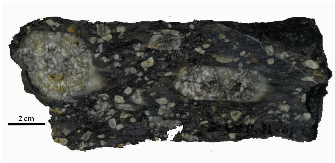
Foto 2.10: Detalle textural del ortogneis glandular; la matriz tiene un color gris oscuro, algo azulado. Se puede apreciar el carácter bimodal de los feldespatos. En la glándula de feldespato potásico que hay en el lado izquierdo se aprecia una fina orla marginal formada por un agregado de pequeños cristales de plagioclasa albítica.
